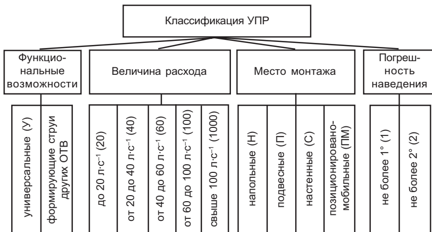
Рис. 2.9. Классификация установок пожаротушения роботизированных (УПР) по ГОСТ Р 53326-2009
