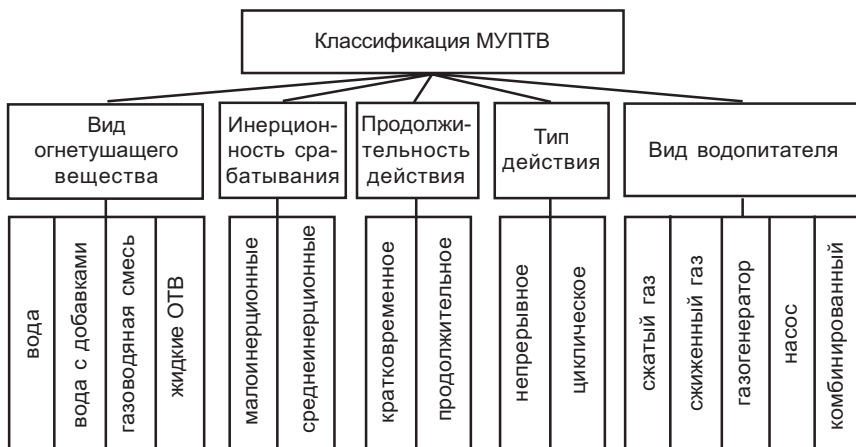
Рис. 2.4. Классификация модульных установок пожаротушения тонкораспыленной водой (МУПТВ) или иными жидкими ОТВ по ГОСТ Р 53288-2009 продолжительности действия; типу действия; виду водопитателя.
