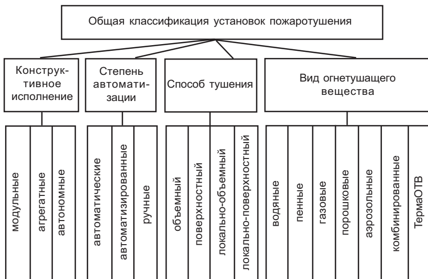
Рис. 2.1. Общая классификация установок пожаротушения
